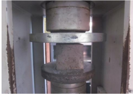
รูปที่ 8 การวางตัวอย่างเพื่อทดสอบกำลังอัด
