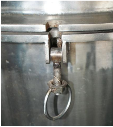
ภาพที่ 4 การติดตั้งน็อตและสกรูยึดตัวหม้อต้มและฝาหม้อต้ม
