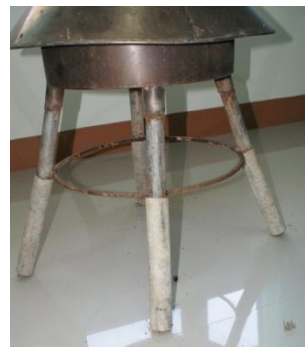
ภาพที่ 9 แสดงท่อต่อสำหรับปรับความสูงของหม้อต้ม
