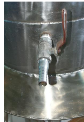
ภาพที่ 6 แสดงวาล์วที่ติดตั้งไว้กันหม้อสำหรับถ่ายน้ำหมักที่เหลือใช้
