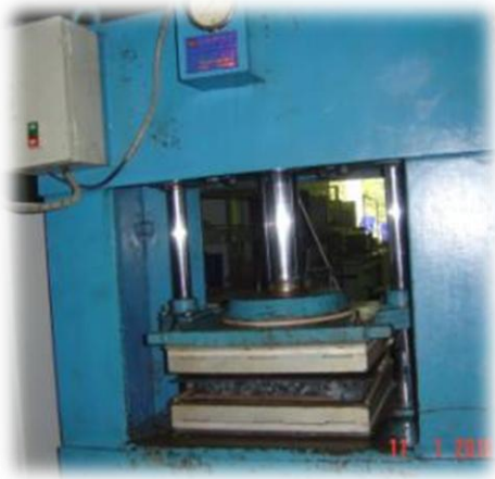
7. เข้าเครื่องอัดร้อนตามสภาวะที่กำหนดจนเกิดการ Polymerization ของกาวทำให้เศษผ้าจับตัวกัน
