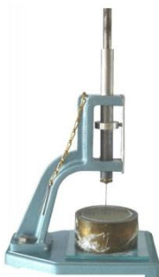
รูปที่ 2 เครื่องทดสอบไวแคต (Vicat Apparatus)
