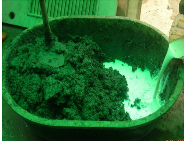
รูปที่ 4 การผสมน้ำยางธรรมชาติลงในดินเหนียวสำหรับทำชั้นดินเหนียวบดอัด
