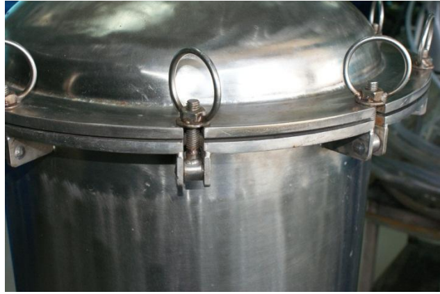
ภาพที่ 4 การติดตั้งน็อตและสกรูยึดตัวหม้อต้มและฝาหม้อต้ม
