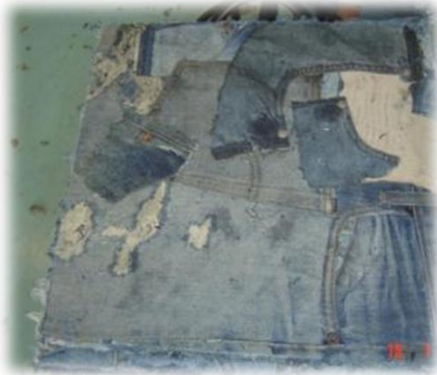
7. เข้าเครื่องอัดร้อนตามสภาวะที่กำหนดจนเกิดการ Polymerization ของกาวทำให้เศษผ้าจับตัวกัน
